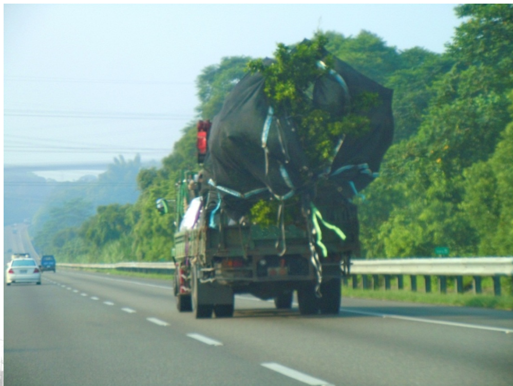
圖 5-26 喬木植株吊置於車上時，應以橫跨木柱以供莖依附，並以繩索固定進行運送，以免下側枝條折斷或損傷。運送過程中應以覆蓋物保護植栽，以免強風烈日危害，造成乾枯與受損（蔡智賢/提供）
