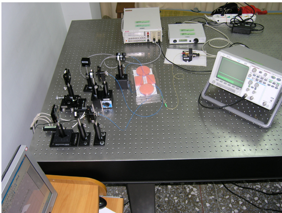
圖五、1304 nm SLD 寬頻光源低同調干涉儀系統實體圖
