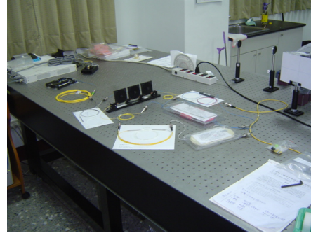
圖 1 波長可調摻鉕光纖雷射實驗架構圖及實際拍攝圖
